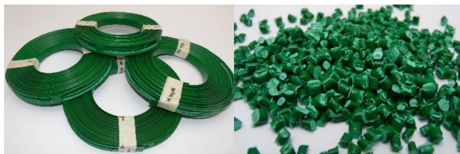
Figura 8. Perfiles de extrusión a partir del material plástico de las cubiertas de los racimos de las bananas
