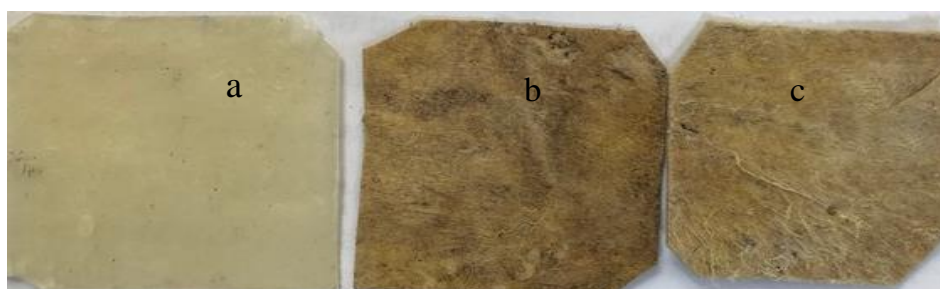
Figura 2 a) Compósito TPS/PEBD como preparado: b) Compósito TPS/PEBD após 60 dias de compostagem: c) Compósito TPS/PEBD após 90 dias de compostagem.
