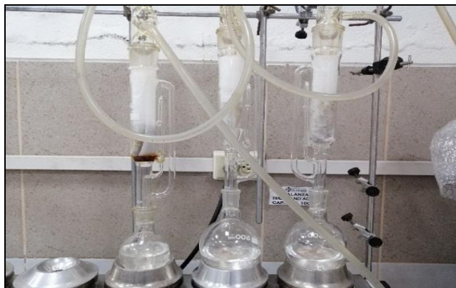
Figura 2. Recirculación mediante equipo Soxhlet. Fuente: Los autores.
